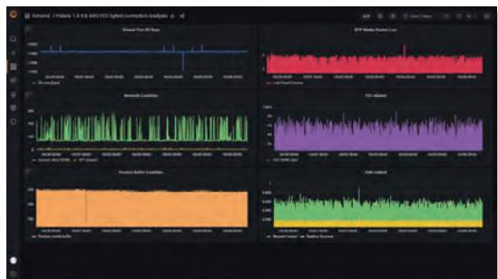
パケットロス対策機構である FEC と ARQ を併用し、欠落補完していますが、0.02% のロスは救済できていないことが分かります。理由としては、この網では Round Trip Time (RTT) の最大値が 32msec と大きく、かつ揺らぎがありますが、受信バッファの設定が不十分であり、再送要求のトライアル回数を十分に確保できない状況が発生しているために、0.02% のパケットが救済できず映像の乱れが生じています。
